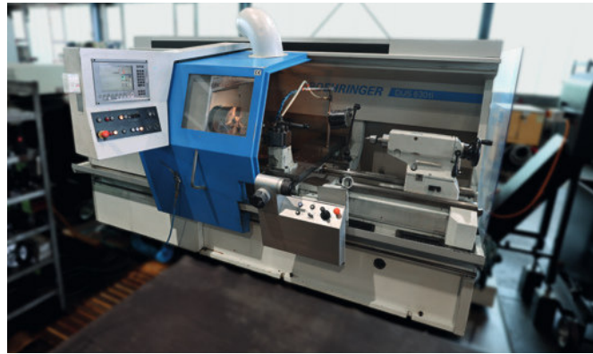
BOEHRINGER DUS 630ti Ø 640 mm über Bett Ø 435 mm über Support 1.000 mm Drehlänge
