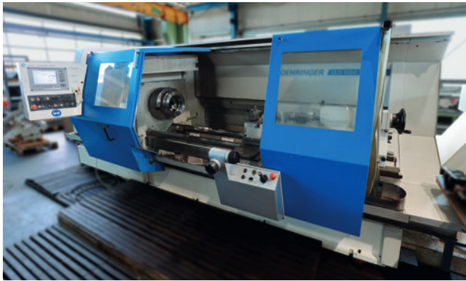
BOEHRINGER DUS 800ti Ø 800 mm über Bett Ø 500 mm über Support 2.000 mm Drehlänge
