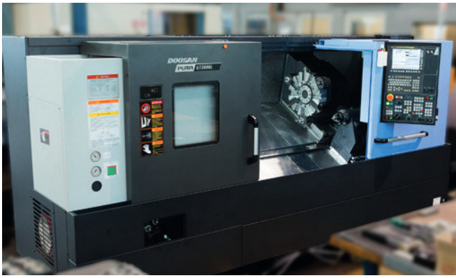
DOOSAN PUMA GT2600L Futter-Ø 275 mm (max. Dreh-Ø 460 mm) Drehlänge: 1.078 mm Revolver: 12 Werkzeuge
